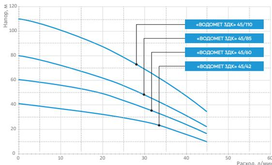
\* Заявленные характеристики были получены при испытании с холодной чистой водой без газа и абразивных примесей, а также напорной магистралью согласно модели насоса и напряжением 220 В.
